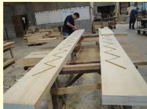
樓梯主架構施作
